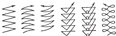
شکل ۳-۳۲- حالت‌های مختلف حرکت نوسانی نوک الکتروود
